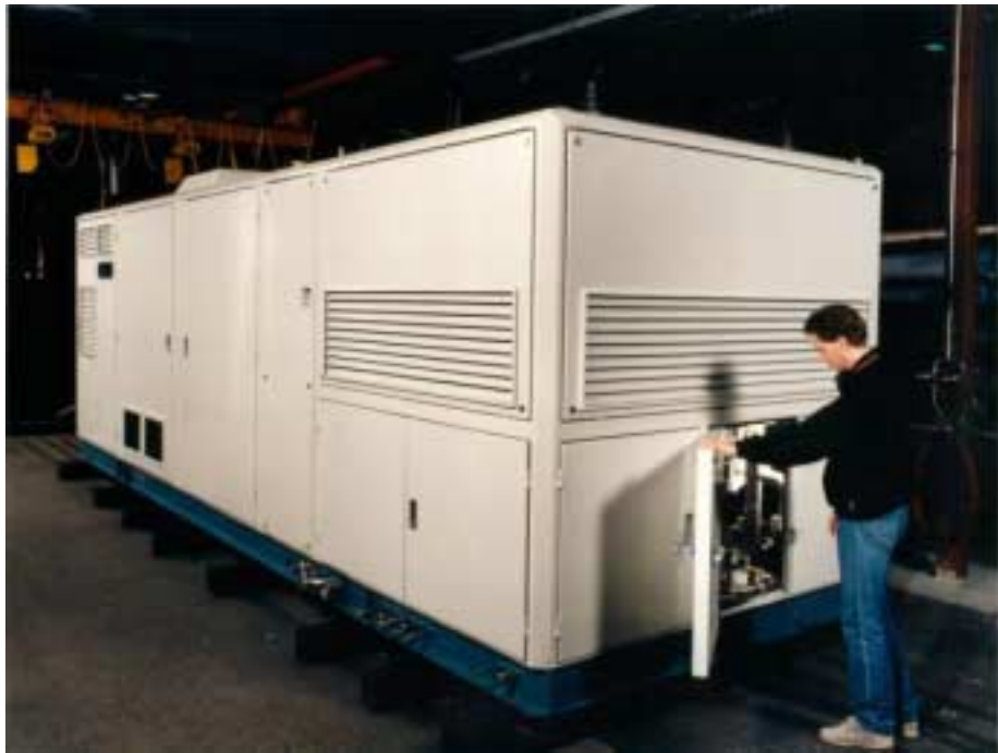
250kW el PEM-System (Ballard) für Haustechnik (Kraft-/Wärmekopplung)
