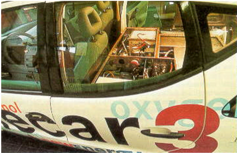
Bild 4: Der Necar3 mit einer PEMFC und Methanol als Brennstoff
