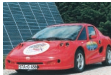
Anlage mit solarer Wasserstoffherzeugung durch Elektrolyse, Wasserstoffdruck-Speicherung und Automobil mit Brennstoffzellen-Antrieb.
